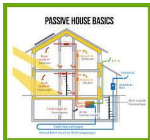
Toplotna energija zemlje kroz mrežu cevi položene na dubini iskopa od 4 m ispod kote tla je ujedno i izmenjivač toplote i prirodni "termofoam" bez obzira na vremenski period sa konstantnom temperaturom od 12-15 C. Tek tako pripremljen vazduh se ubacuje u korisni deo stambenog prostora.
